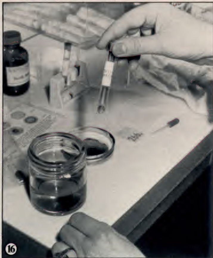
16 Nun wird das Röhrchen mit Wasser aufgefüllt, ca. eine Minute geschüttelt und anschließend in einem Ständer senkrecht aufgestellt
